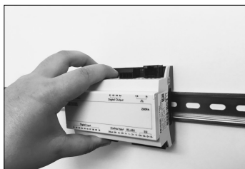
Abb. 6: Gerät auf Hutschiene aufsetzen
